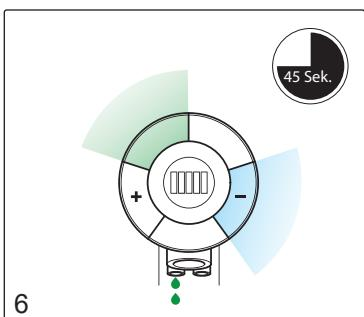
Activeer de zeep en "-" sectoren om de zeepleiding te vullen met vloeistof. Na 45 seconden stopt het spoelen automatisch.
