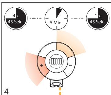
Verwijder de TubeCleanse oplossing uit de linkerzijde van de zeepbox en plaats deze aan de rechterkant van de zeepbox. Activeer de desinfectans en "+" sectoren gelijktijdig. Na 45 seconden stopt het spoelen automatisch. Herhaal de spoeling 4 keer.
