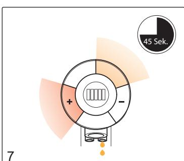
Activeer de desinfectans en "+" sectoren om de desinfectansleiding met vloeistof te vullen. Na 45 seconden stopt het spoelen automatisch.
