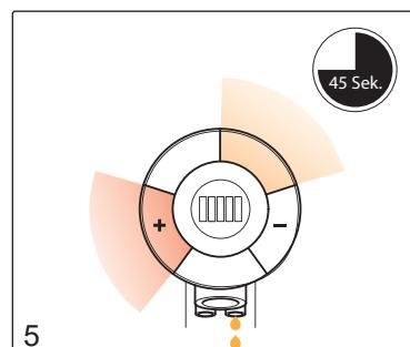
Selecteer de desinfectans en "+" sectoren gelijktijdig. De leiding voor desinfectans wordt nu leeg gepompt. Na 45 seconden stopt het spoelen automatisch.
