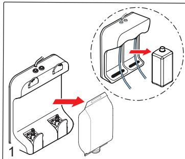
Entnehmen Sie die Flüssigkeitsbeutel / Flüssigkeitsflaschen aus der Seifenbox.
