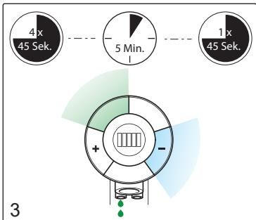
Activeer de zeep en "-" sectoren gelijktijdig. Na 45 seconden stopt het spoelen automatisch. Herhaal de spoeling 4 keer.
