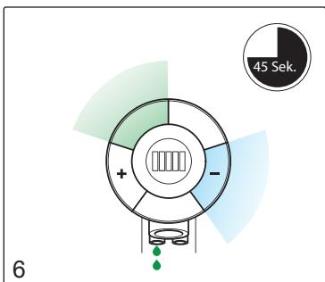
Aktivieren Sie kurz nacheinander die Sektoren „Seife“ und „-“ am Auslauf. Die Spülfunktion beginnt und endet nach 45 Sekunden automatisch. Der Seifenschlauch wird gefüllt.
