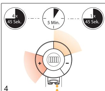
Setzen Sie „miscea TubeCleanse“ in den rechten Platzhalter der Seifenbox ein. Aktivieren Sie kurz nacheinander die Sektoren „Desinfektion“ und „+“ am Auslauf. Die Spülfunktion beginnt und endet nach 45 Sekunden automatisch. Wiederholen Sie diesen Vorgang weitere drei mal.
