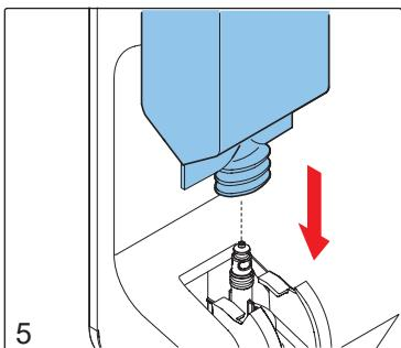
Verwijder de TubeCleanse zak uit de zeepbox en installeer nieuwe zakken vloeistof in de zeepbox.
