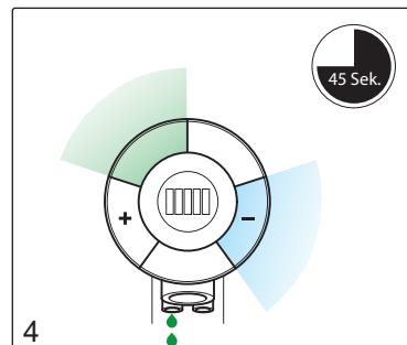
De leiding wordt leeg gepompt door middel van gelijktijdig activeren van de zeep en "-" sectoren. Na 45 seconden stopt het spoelen automatisch.
