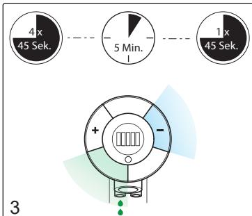
Activeer de "-" sector en de sector linksonder gelijktijdig. Na 45 seconden stopt het spoelen automatisch. Herhaal de spoeling 4 keer.
