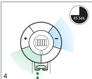
Aktivieren Sie kurz nacheinander den Sektor links unten und den “-“ Sektor am Auslauf. Die Spülfunktion beginnt und endet nach 45 Sekunden automatisch. Der Schlauch wird entleert.
