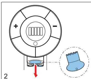
Entfernen Sie den Perlator des Wasserauslaufs mit Hilfe des Perlatorschlüssels.
