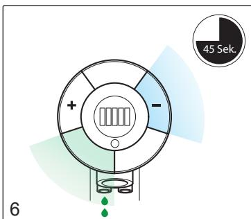
Aktivieren Sie kurz nacheinander den Sektor links unten und den “-“ Sektor am Auslauf. Die Spülfunktion beginnt und endet nach 45 Sekunden automatisch. Der Schlauch wird gefüllt.
