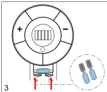
Reinigen Sie den Seifen- und Desinfektionsauslass mit der passenden Minibürste.
