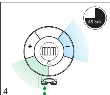
De leiding wordt leeg gepompt door middel van gelijktijdig activeren van de "-" sector en de sector linksonder. Na 45 seconden stopt het spoelen automatisch.
