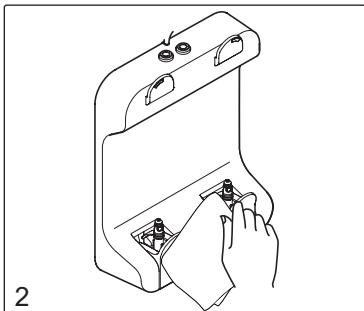
Verwenden Sie den „miscea Foam Glove“ Handschuh oder einen weichen, sauberen Lappen mit Wasser und einem milden Reinigungsmittel um die Oberfläche der Seifenbox sorgfältig zu reinigen.
