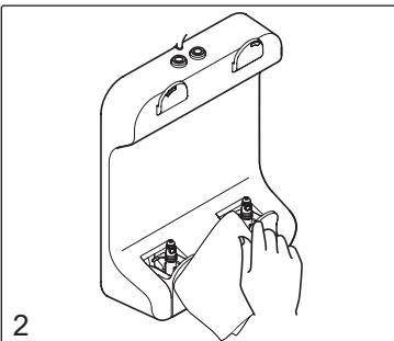
Gebruik de microvezel doek en desinfecteermiddel voor het reinigen van de oppervlakten van de zeepbox. Verwijder eventueel aanwezige zeepresten.
