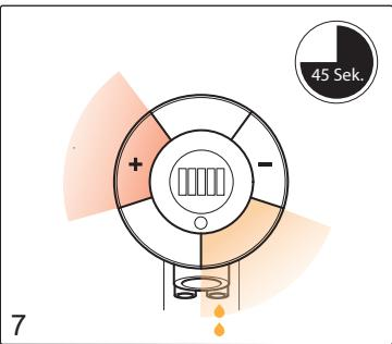
Activeer de "+" sector en de sector rechtsonder gelijktijdig om de desinfectansleiding met vloeistof te vullen. Na 45 seconden stopt het spoelen automatisch.
