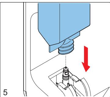
Verwijder de TubeCleanse zak uit de zeepbox en installeer nieuwe zakken vloeistof in de zeepbox.
