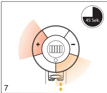
Aktivieren Sie kurz nacheinander den Sektor rechts unten und den “+“ Sektor am Auslauf. Die Spülfunktion beginnt und endet nach 45 Sekunden automatisch. Der Schlauch wird gefüllt.
