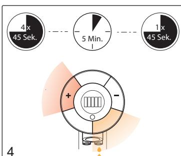
Setzen Sie „miscea TubeCleanse“ in den rechten Platzhalter der Seifenbox ein. Aktivieren Sie kurz nacheinander den Sektor rechts unten und den “+“ Sektor am Auslauf. Die Spülfunktion beginnt und endet nach 45 Sekunden automatisch. Wiederholen Sie diesen Vorgang weitere drei mal.
