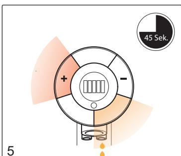
Aktivieren Sie kurz nacheinander den Sektor rechts unten und den “+“ Sektor am Auslauf. Die Spülfunktion beginnt und endet nach 45 Sekunden automatisch. Der Schlauch wird entleert.
