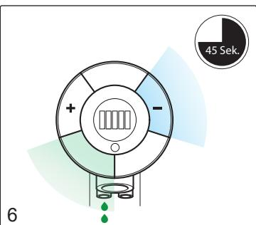
Activeer de en "-" sector en de sector linksonder gelijktijdig om de zeepleiding te vullen met vloeistof. Na 45 seconden stopt het spoelen automatisch.
