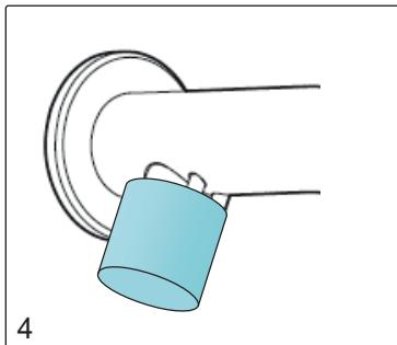
Um den Wasserauslass zu entkalken, füllen Sie den Kunststoffbecher mit Wasser und Essig im Verhältnis 1:1. Stecken Sie den gefüllten Kunststoffbecher über den Wasserauslass und die Auslässe für Seife und Desinfektion.
