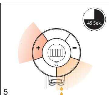
Selecteer de "+" sector en de sector rechtsonder gelijktijdig. De vloeistofleiding wordt nu leeg gepompt. Na 45 seconden stopt het spoelen automatisch.
