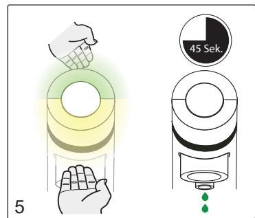
Activeer de zeep en de water sectoren gelijktijdig. Na 45 seconden stopt het spoelen automatisch.
