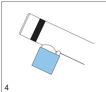
Ontdoe de wateruitloop van kalk. Hiertoe dient het plastic bekertje gevuld te worden met azijn en water (mengverhouding 1:1). Het bekertje kan nu over de water -en zeepuitloopjes geschoven worden. Zorg ervoor dat de uitloopjes door de vloeistof omvat zijn.
