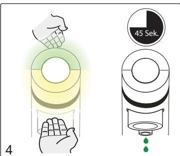
De leiding wordt leeg gepompt door middel van gelijktijdig activeren van de zeep en water sectoren. Na 45 seconden stopt het spoelen automatisch.
