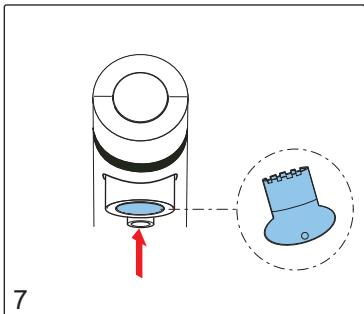
Nach der Reinigung kann der neue Perlator mit dem Perlatorschlüssel eingeschraubt werden.
