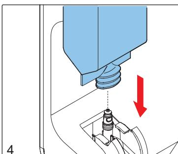
Verwijder de TubeCleanse zakken uit de zeepbox en installeer nieuwe zakken vloeistof in de zeepbox.
