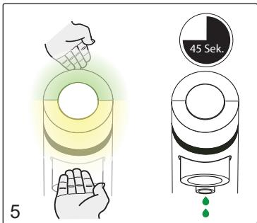
Aktivieren Sie kurz nacheinander die Sektoren "Seife" und "Wasser" am Auslauf. Die Spülfunktion beginnt und endet nach 45 Sekunden automatisch. Der Seifenschlauch wird gefüllt.
