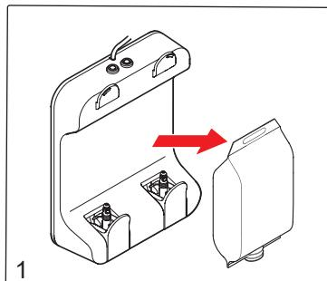
Entnehmen Sie die Flüssigkeitsbeutel aus der Seifenbox.
