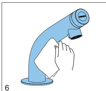
Gebruik de microvezeldoek of de Foam Glove handschoenen voor het reinigen van de kraan.
