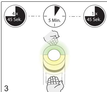
Activeer de zeep en de water sectoren gelijktijdig. Na 45 seconden stopt het spoelen automatisch. Herhaal de spoeling 4 keer.
