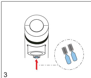
Reinigen Sie den Seifenauslass mit der passenden Minibürste.
