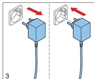
Trek de stekker uit het stopcontact en steek hem na 10 seconden weer terug in het stopcontact.
